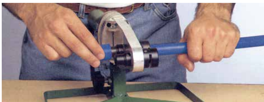
Corte de peças unidas por termofusão.
